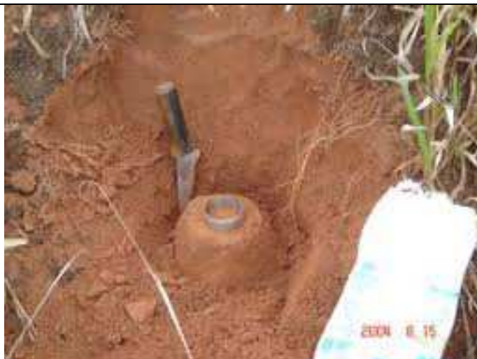
Figura 5 – Coleta de amostra direto nos anéis de ensaio para o Cisalhamento Direto e Adensamento.
