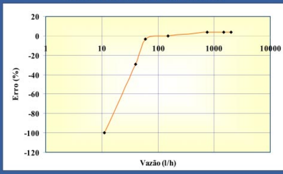
FIGURA 4 - CURVA CARACTERÍSTICA DE ERROS DO MEDIDOR A97T122344, MATRICULA 3634140, PALMEIRA-PR, PERÍODO DE 1 A 8.06.2000
