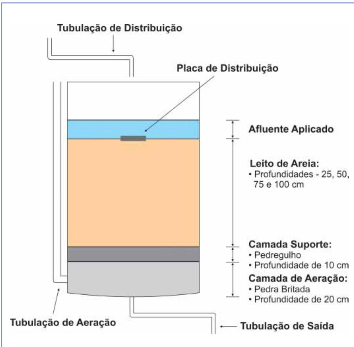
*para a distribuição uniforme do afluente, empregou-se uma placa quadrada de 20 cm de comprimento*
