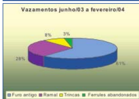
FIGURA 12 - REPRESENTATIVIDADE DOS TIPOS DE VAZAMENTOS ENCONTRADOS
