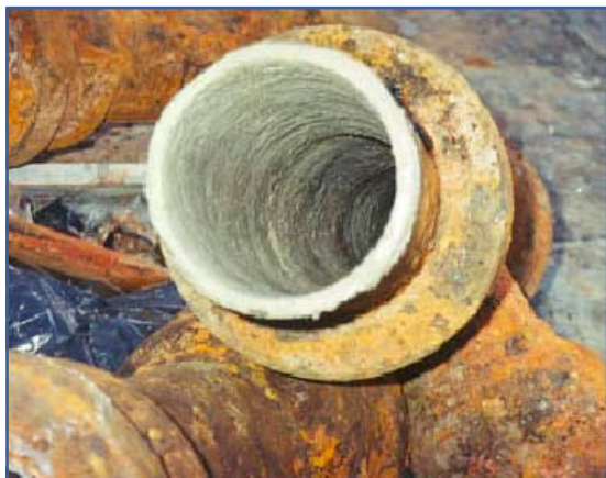
FIGURA 7 – CONEXÃO REVESTIDA MANUALMENTE
