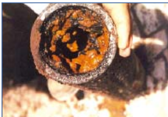
FIGURA 3 – AMOSTRA DE INCRUSTAÇÃO NA REDE DE FERRO FUNDIDO CINZENTO
