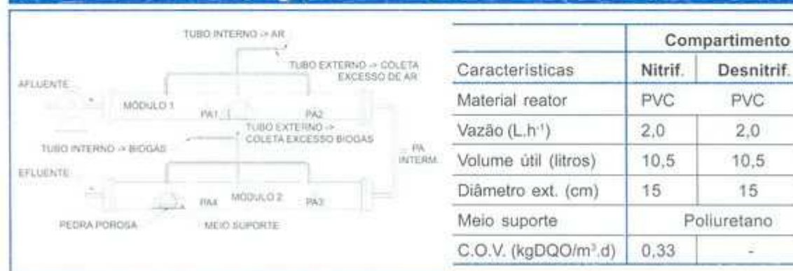
FIGURA 2 - ESQUEMA E PRINCIPAIS CARACTERÍSTICAS DO RAAHLF
