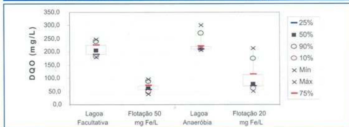
FIGURA 6 - CONCENTRAÇÕES DE DQO NOS EFLUENTES DA LAGOA ANAERÓBIA E DA LAGOA FACULTATIVA, ANTES E DEPOIS DO TRATAMENTO FÍSICO-QUÍMICO
