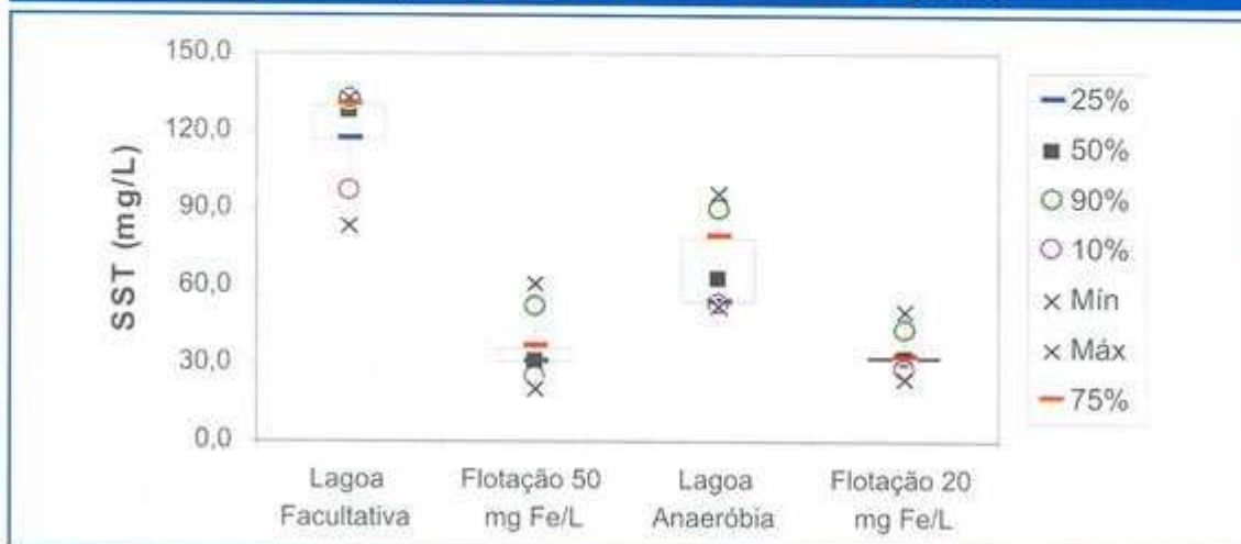
FIGURA 7 - CONCENTRAÇÕES DE SST NOS EFLUENTES DA LAGOA ANAERÓBIA E DA LAGOA FACULTATIVA, ANTES E APÓS O TRATAMENTO FÍSICO-QUÍMICO
