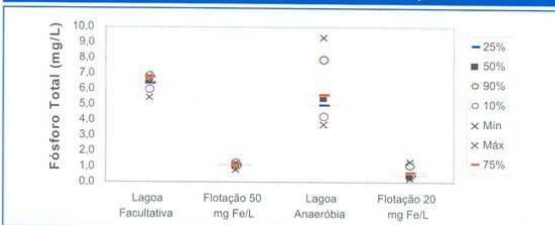
FIGURA 5 - CONCENTRAÇÕES DE FÓSFORO NOS EFLUENTES DA LAGOA ANAERÓBIA E DA LAGOA FACULTATIVA, ANTES E DEPOIS DO TRATAMENTO FÍSICO-QUÍMICO
