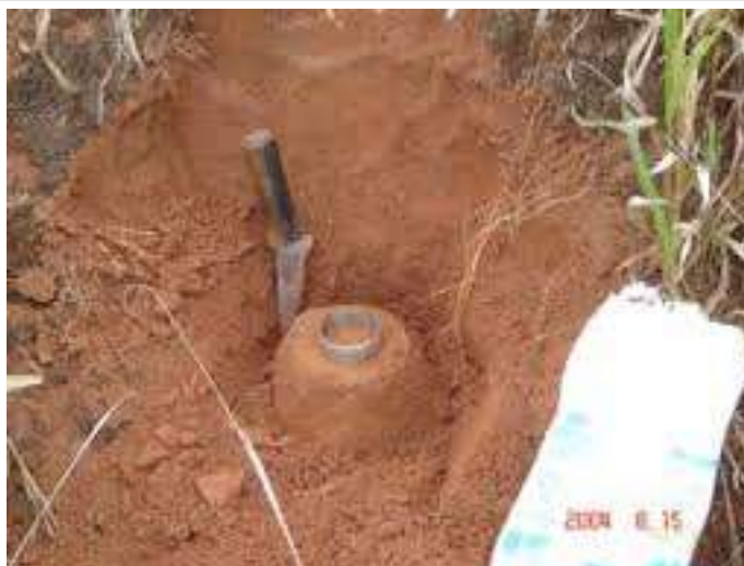
Figura 9 – Coleta de amostra direto nos anéis de ensaio para o Cisalhamento Direto e Adensamento.
