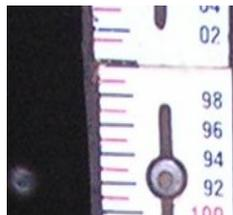
As réguas possuem numerações distintas, por exemplo: de 0 a 100, de 100 a 200, de 200 a 300, etc. Desta maneira, pode-se instalar as réguas em diferentes locais, para facilitar a leitura durante uma cheia.
