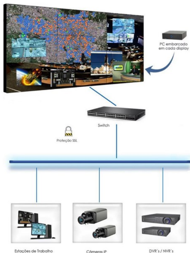
Figura 2 – Topologia de aplicação de videowall
